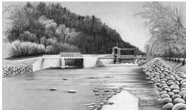
Visualisierung des Stollenauslaufbauwerks unterhalb des Wichelsees (links). Rechts das Stauwehr des Wichelsees.
