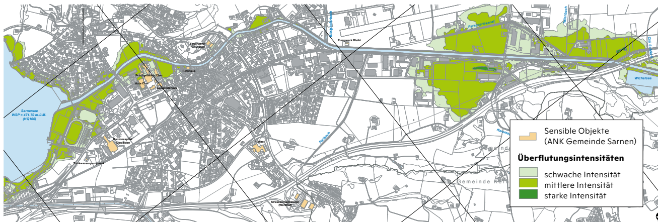
Intensitätskarte zwischen dem Sarnersee und dem Wichelsee vor Realisierung des Projekts Hochwassersicherheit Sarneraa für ein Hochwasser der Wiederkehrperiode 30–100 Jahre. Die überfluteten Flächen sind deutlich zu sehen.
